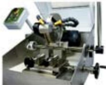
La visto governo della **MICROMET** consente il taglio di qualsiasi campione petrografico, dai grossi spiccioli di roccia a siai cestini di grandi dimensioni vasellinati con la **MIC 500**, ai piccoli frammenti di minerali riducibili a sezioni sottili piano parallele mediante la microtessile di precisione **MICROMET**.
